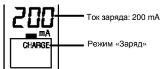
Во время зарядки можно выбрать режим отображения информации на LCD-дисплее между током заряда (mA), временем зарядки (ч:мм), установившимся напряжением (V) и накопленной ёмкостью (mAh или Ah) за время процесса заряда при помощи клавиши DISPLAY (ДИСПЛЕЙ) (см. таблицу 4).
