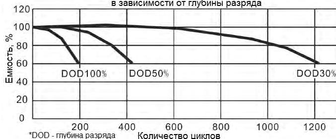
Количество жизненных циклов батареи в зависимости от глубины разряда
