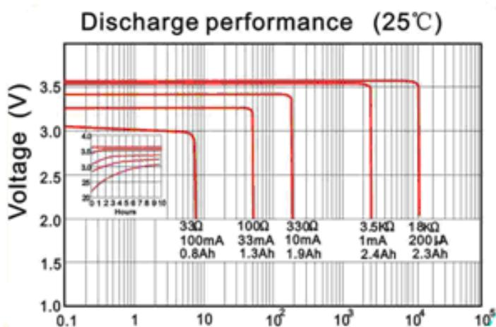
Зависимость напряжения на элементе питания от температуры элемента питания и тока разряда:
